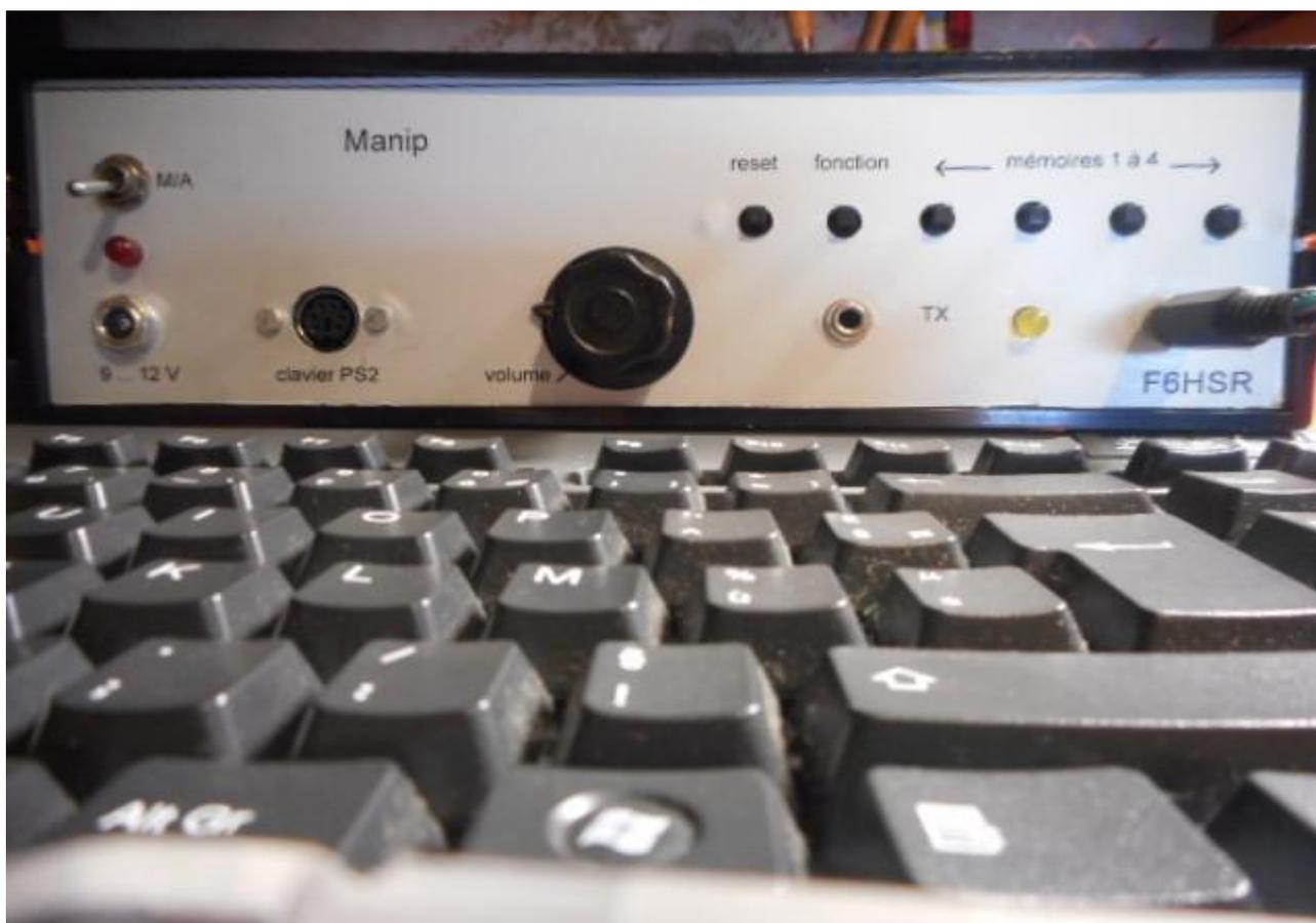
C'est une réalisation amusante basée sur l'ARDUINO UNO. Une fois le sketch mis au point et téléversé, j'ai récupéré le microcontrôleur (ATMEGA 328P) pour le mettre sur un SHIELD réalisé avec EAGLE.
